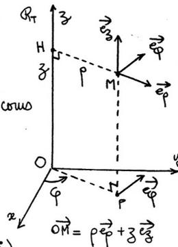
a)  $\vec{v}_{M/R} = \begin{pmatrix} \dot{\rho} \\ \rho\dot{\varphi} \\ \dot{z} \end{pmatrix}$  dans la base  $(\vec{e}_\rho, \vec{e}_\varphi, \vec{e}_z)$
