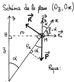
$$1) \text{ PFD dans } R_T \text{ suppose galiléen appliqué au système } \{M; m\}: m \vec{a}_{M/R_T} = \vec{P} + \vec{R}$$
