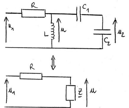
d'où  $H = \frac{\frac{C_2}{C_1 + C_2}}{1 + j(RC\omega - \frac{R}{L\omega})}$
