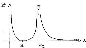
On a une singularité pour  $N(\omega) = 0$  soit  $\omega = \omega_1 = \frac{1}{\sqrt{L_1 C_1}}$
