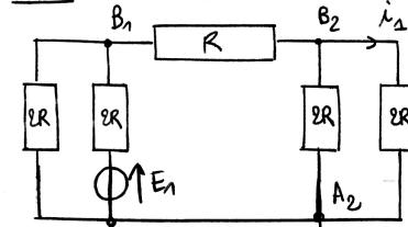
l'intensité  $i_1$  est aussi l'intensité circulant dans la branche  $(B_2 A_2)$ .
